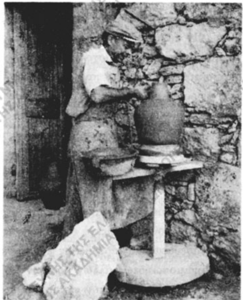
Εἰκ. 1. Τὸ τροχί. (Κατασκευὴ πιθαριοῦ). Εἰκ. 2. Ὁ τροχός. (Κατασκευὴ σταμνιοῦ).
