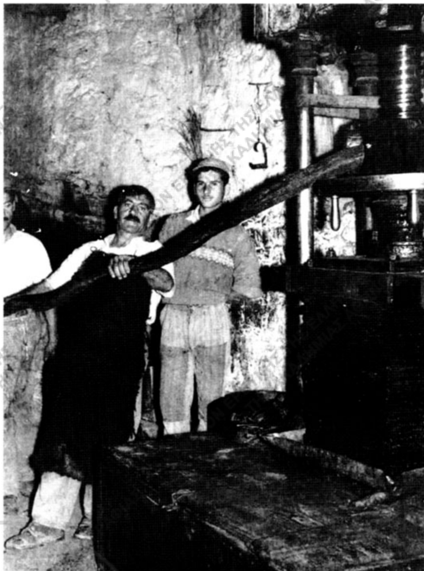
Εικ. 6. Οι εργάτες ελαιοτριβείου (αλιτριβιδιάρηδες) στο Λασιθί γυρίζουν με δύναμη τον μοχλό, που κατεβάζει το πάνω μέρος της φάμπρικας, για να συμπιεστούν οι ελιές.
