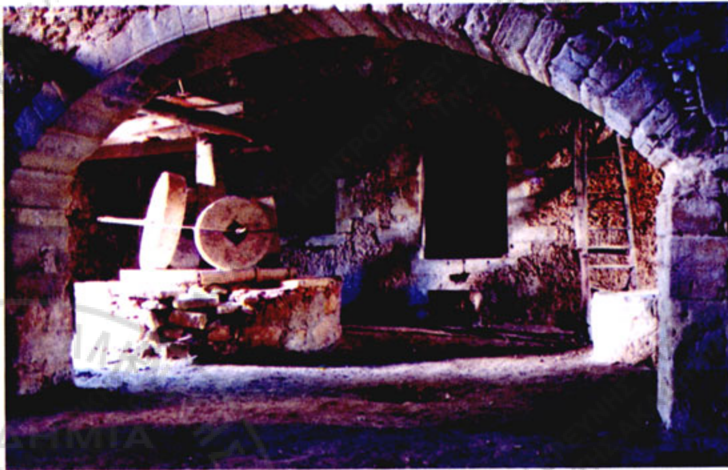
Εικ. 4. Παλιό ελαιοτριβείο σε καμαρόσπιτο κοντά στον Άγιο Παύλο περιοχής Βάμου, επαρχίας Αποκορώνου Χανίων, με τις μυλόπετρες πάνω στη βάση που γύριζαν και άλεθαν τις ελιές. (Φωτ. Χρυσούλας Ζήκου, Χανιά, 1999).
