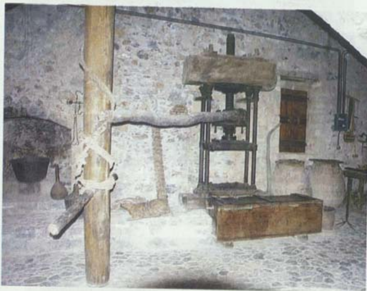
Εικ. 7. Ελαιοτριβείο της οικογένειας Παρλαμά με πιεστήριο που έχει 4 κατακόρυφους σιδερένιους στύλους και προέρχεται από μηχανουργείο των Χανίων. Αριστερά το τζάκι, όπου ζεσταινόταν το νερό, δεξιά λαδοπίθαρα. Βρίσκεται στο Πισκοπιανό Πεδιάδας Ηρακλείου και έχει αναστηλωθεί και λειτουργεί ως αγροτικό λαογραφικό Μουσείο της Εταιρείας Κρητικών Ιστορικών Μελετών. (Φωτ. Νίκου Μιχελάκη, διευθ. του Σ.Ε.Δ.Η.Κ., Χανιά, τον οποίο ευχαριστώ και από εδώ).
