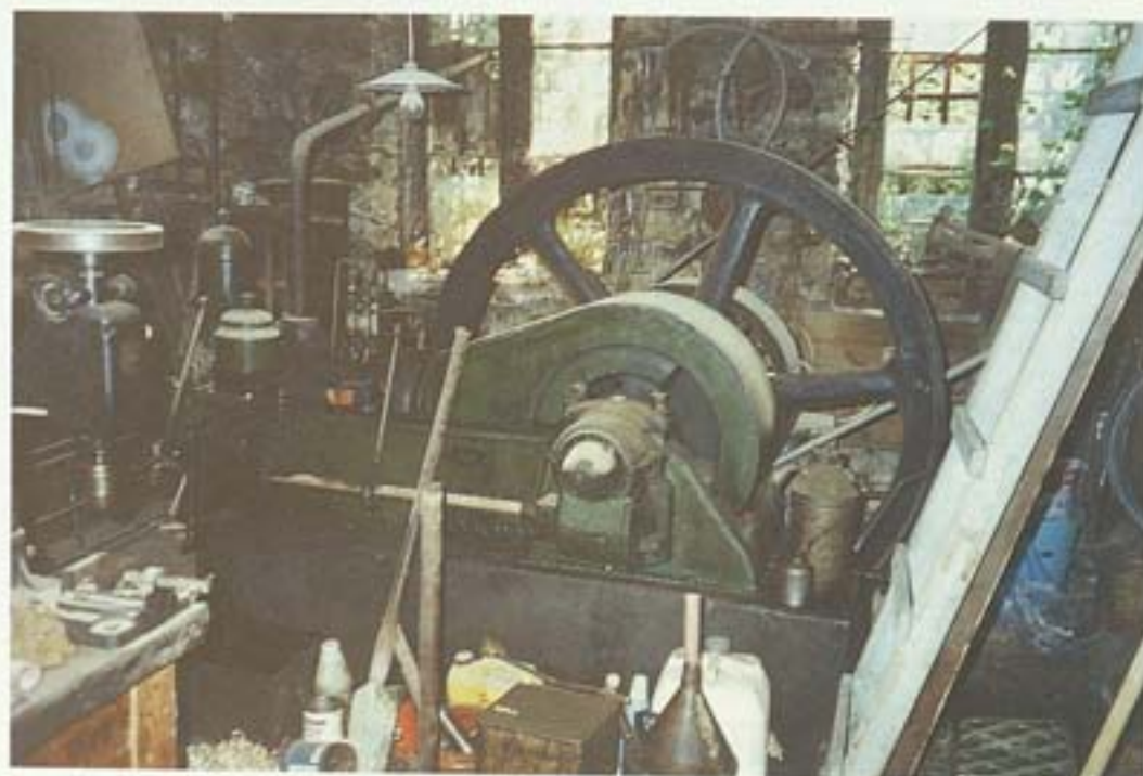
Εικ. 12. Πετρελαιοκίνητη μηχανή σε μηχανοκίνητο ελαιοτριβείο (Προσήλιο Λακωνίας 1992, φωτ. Α. Οικονόμου).
