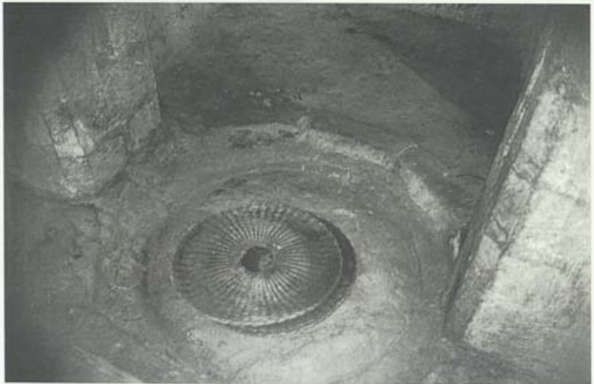
Εικ. 12. Βάση πιεστηρίου, ελαιόσακκος, ληνός, χεύλη προστασίας του ρέοντος ελαιολάδου.
