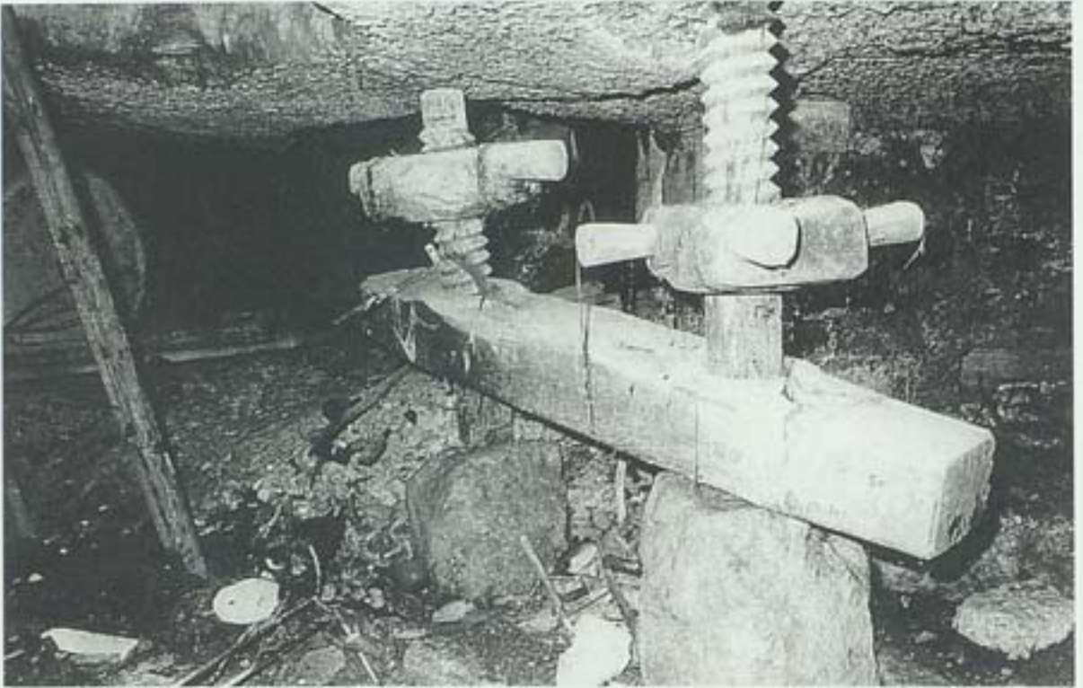
Εικ.7. Σωζόμενες ξύλινες βίδες, σφικτήρες σύνθλιψης ελαιοζύμης.
