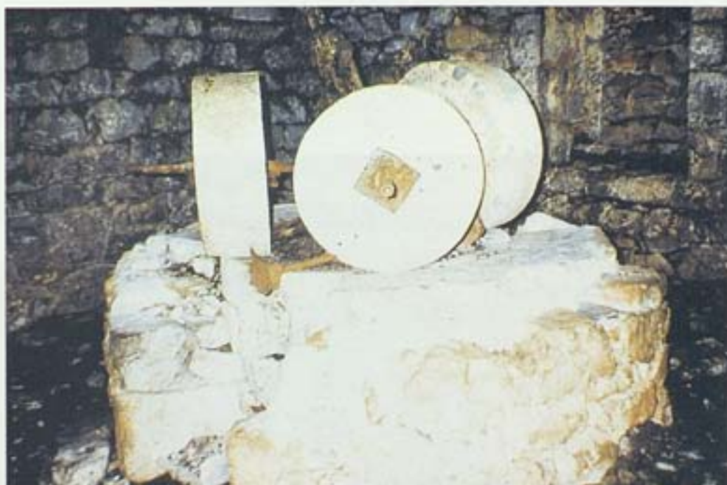
Εικ. 7. Ζωοκίνητο λιοτρίβι με τρεις μολόπετρες (Μάνη 1998, Φ. Α. ΠΤΙ. ΕΓΒΑ, φωτ. Π. Μπαγετάκου).
