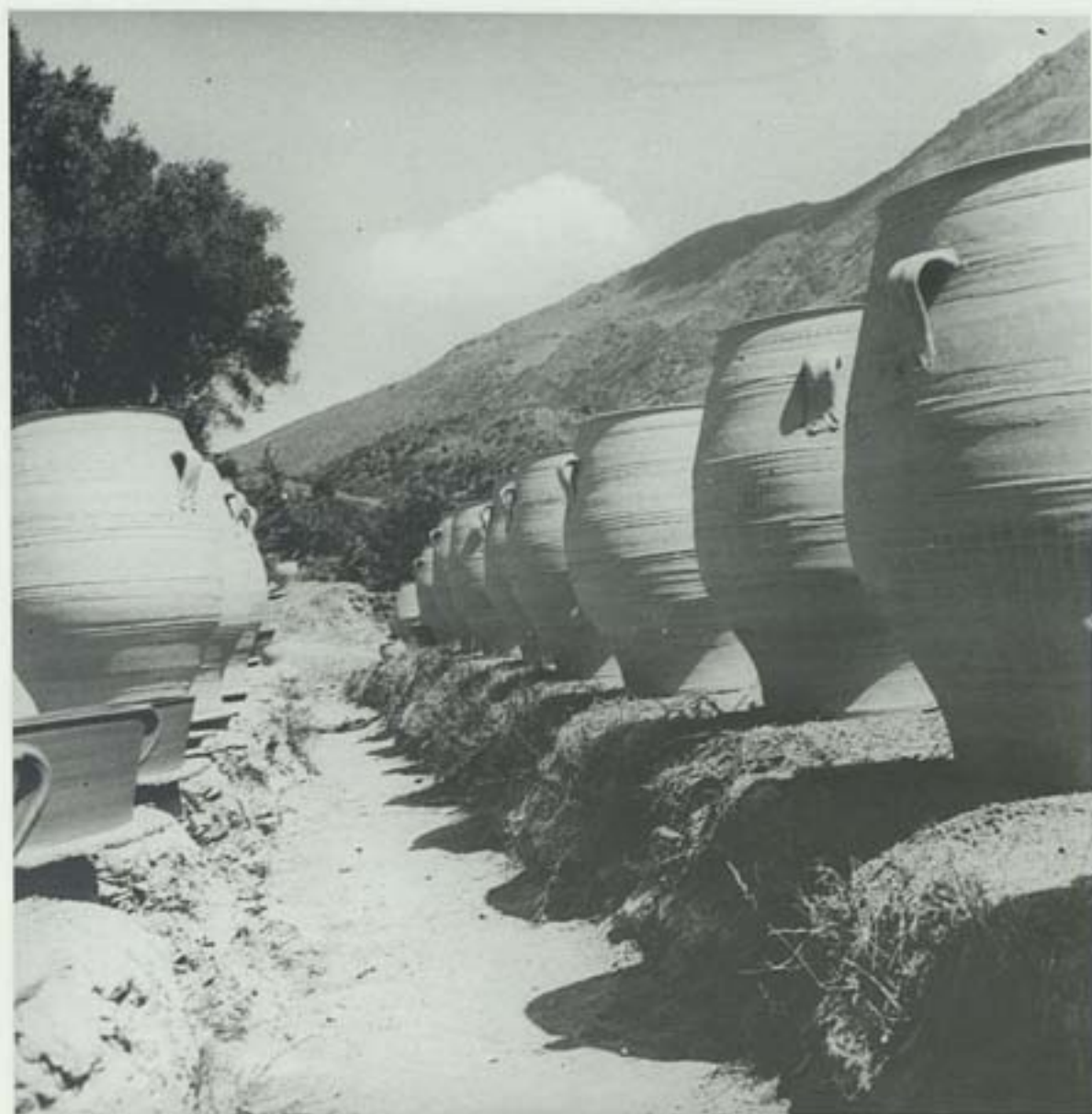
Εικ. 5. Σειρές πιθαριών που αποξηραίνονται πριν τοποθετηθούν στο καμίνι.
