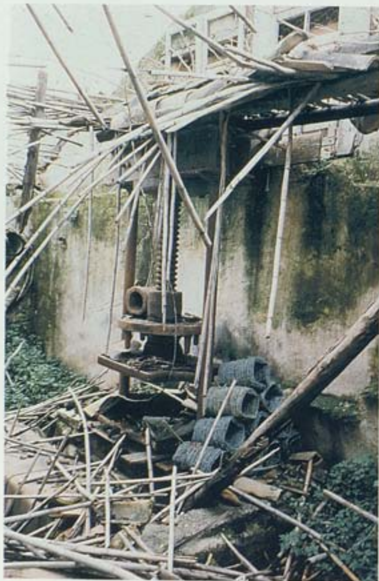
Εικ. 11. Ιπποκίνητο αρχικά και μετά μηχανοκίνητο ελαιοτριβείο (Μέλπεια Μεσσηνίας, 1998).
