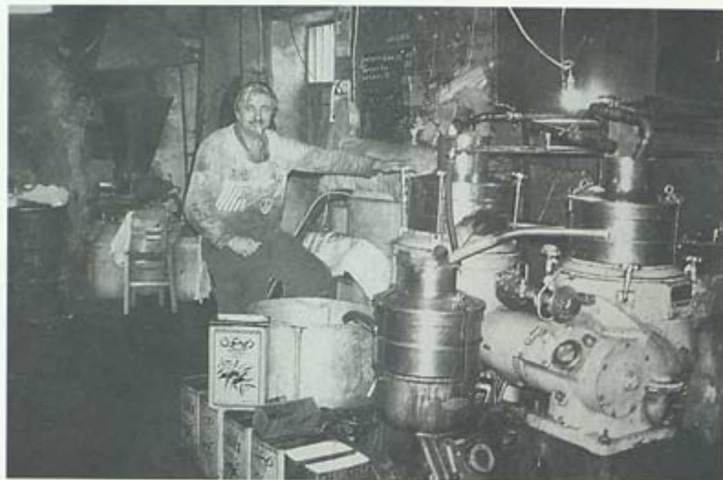
Εικ. 11. Ο διαχωριστήρας σε ηλεκτροκίνητο «κλασικό» ελαιοτριβείο (Χρύσαφα Λακωνίας, Φ. Α. ΠΤΙ. ΕΤΒΑ, φωτ. Π. Μπαγετάκου).
