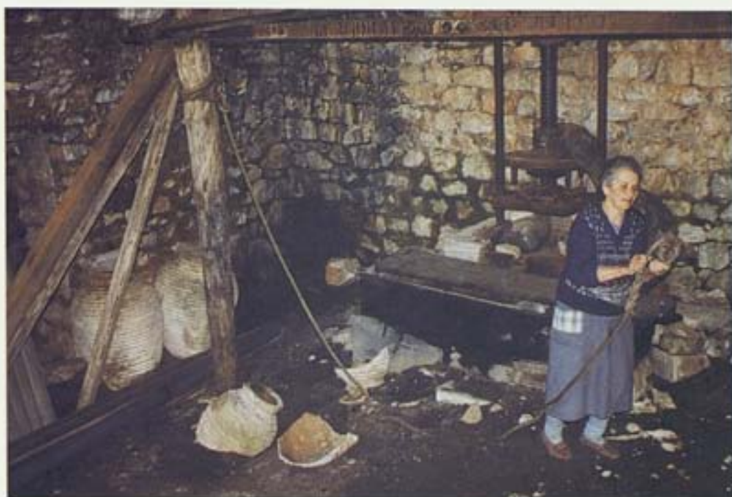
Εικ. 9. Χειροκίνητη σιδερένια πρέσσα με τη «μανέλα» και τον «εργάτη». Διακρίνονται το ξύλινο λυμπί και τα πιθάρια (Πιόντες, Μάνη 1999, Φ. Α. ΠΤΙΕΤΒΑ, φωτ. Π. Μπαγετάκου).
