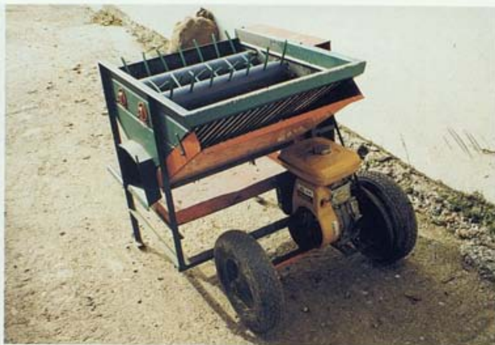
Εικ. 15. Μηχανοκίνητος «γάιδαρος» για την ελαιοσυλλογή. (Πετρίνα 1998, Φ. Α. ΠΤΙ. ΕΤΒΑ, φωτ. Π. Μπαγετάκου).
