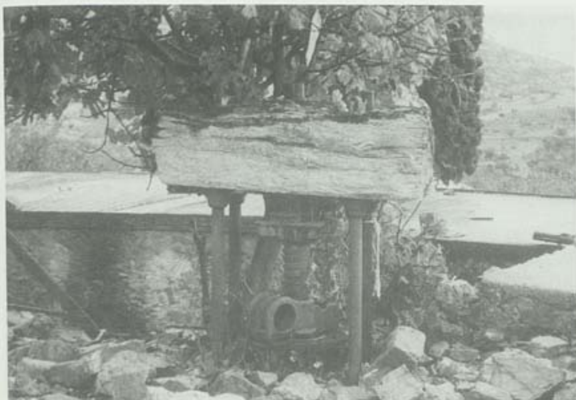
Εικ.17. Επάνω τμήμα ελαιοπιεστηρίου με 4 σιδερένιους στύλους. Κουρούτες.
