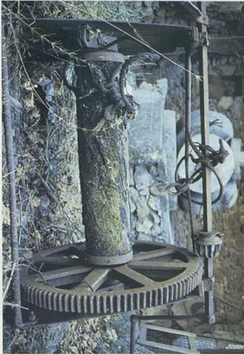
Εικ. 11. Μηχανισμός πιεστηρίου φάμπρικας, Κάντανος Χαλίων.
