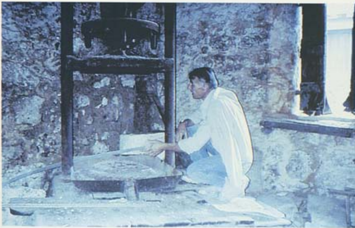
Εικ. 2. Το πιεστήριο στο λιοτριβι του Διγενή.
