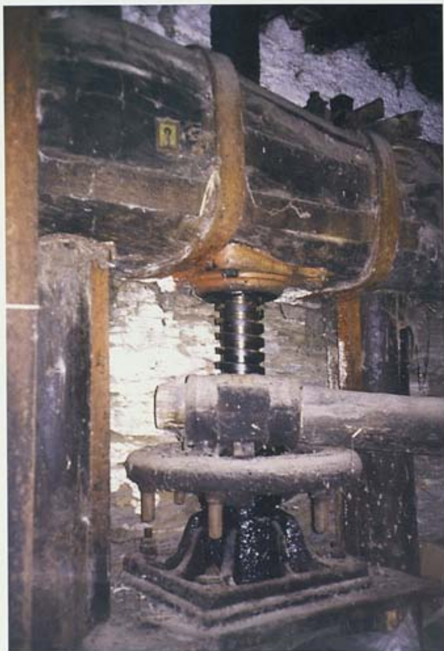
1. Βιτάλι Άνδρου, Λιοτριβί σε εγκατάλειψη, διακρίνεται η βίδα.
