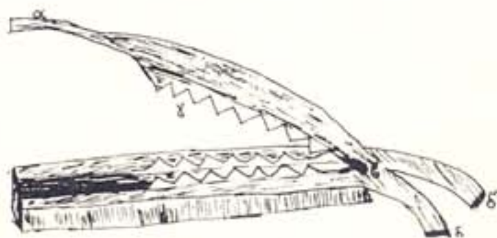
Είκ. 212. Μαγγάνι λιναριοῦ: α χέρι, β σίδηρο μαγγανιοῦ, γ δόντια, δ πόδια (Ζιζάνι Πυλίας, σ. 150)
