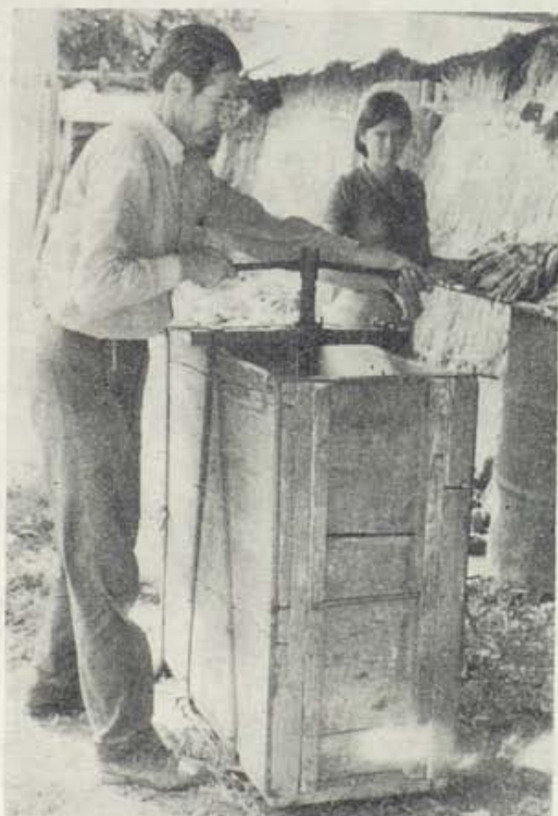
Εικ. 205. Μηχάνημα για τὸ βελόνιασμα τοῦ καπνοῦ (Κατερίνη, σ. 139)
